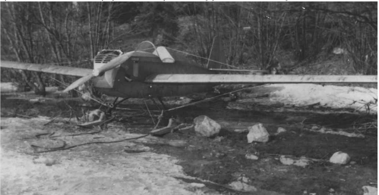
Kyrölään kone ensimmäisten lentoyritysten aikoihin. Pyöräteline oli jäykkä, mutta suksissa oli jousitus. Kuva: via K-SIM.
